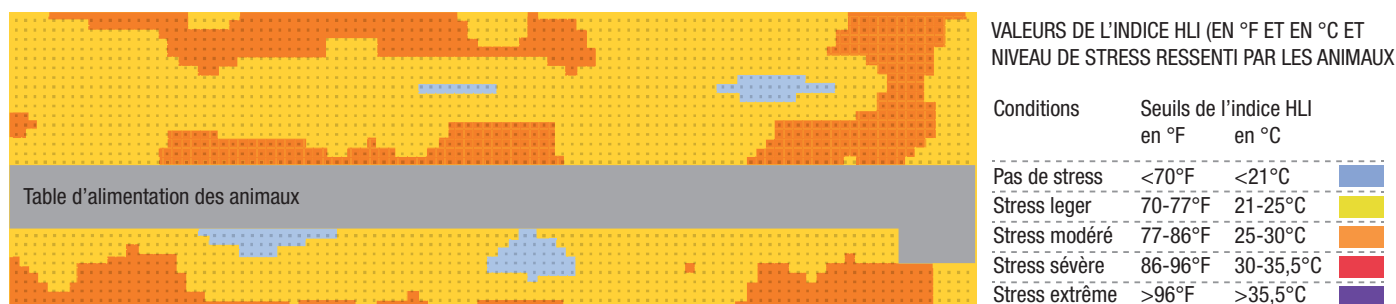
Figure 5. Cartographie « thermique » d'un bâtiment à partir de l'utilisation du HLI
